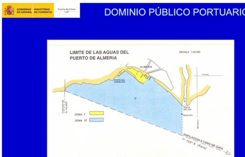
Fig. 1: Ejemplo de la división de las aguas del puerto en Zona 1 y Zona 2<sup>27</sup>.
